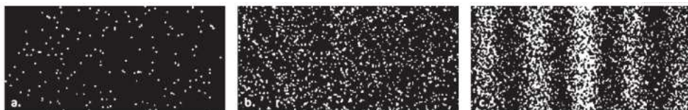
Fig. 8 Figures d'interférences photon par photon : a. après impact de 200 photons. b. après impact de 2000 photons. c. après impact de 6 000 photons.
