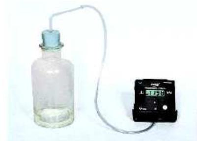
► **Doc. 9** Manomètre mesurant la pression  $P = P(\text{CO}_2) + P(\text{air})$ , en hPa, dans le flacon.
